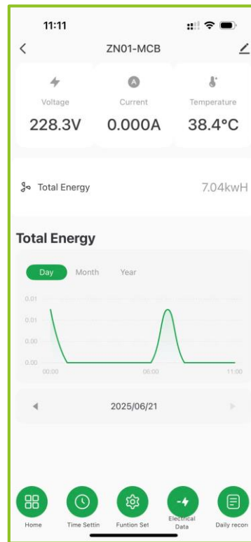
Màn hình Electric data Kiểm tra điện năng, dòng điện, nhiệt độ dây...
